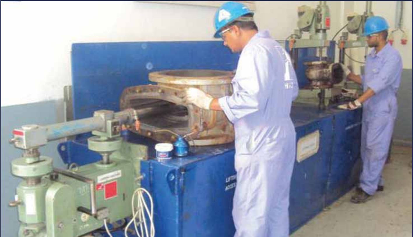
أعمال صيانة الصمامات وتقديم خدمات
