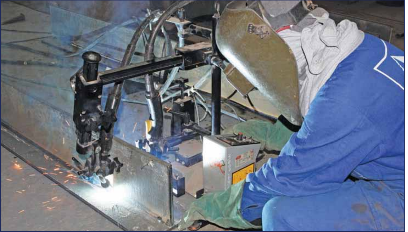
أعمال لحام قوسي للوح T باستخدام جهاز أوتوماتيكي
